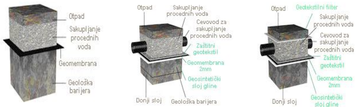
Slika 5.22 Prikaz donjih slojeva deponije
