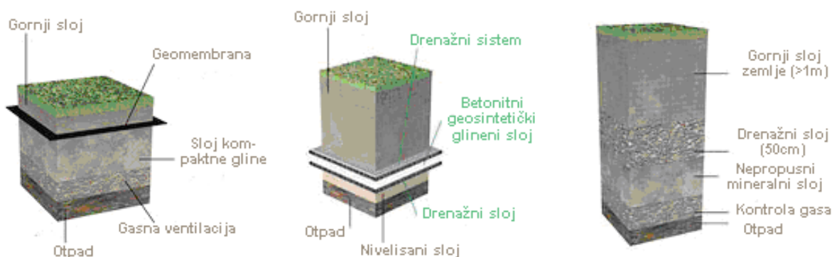
Slika 5.13. Prikaz gornjih pokrivnih slojeva deponije
