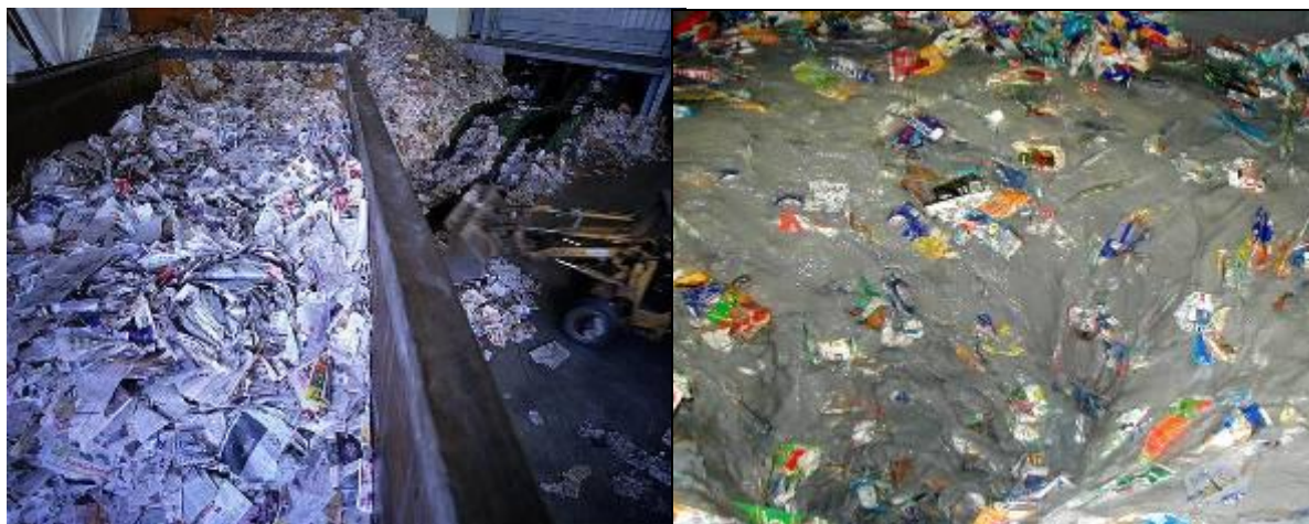
Slika 4.3. Prijem papira i proces njegovog ispiranja
