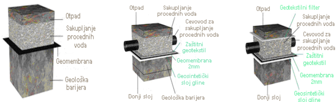
Slika 5.17. Prikaz donjih slojeva deponije
