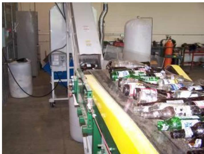
Slika 4.7. Postrojenje za reciklažu stakla
