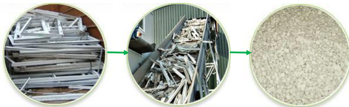
Slika 4.6. Dobijanje granulata od PVC prozora
