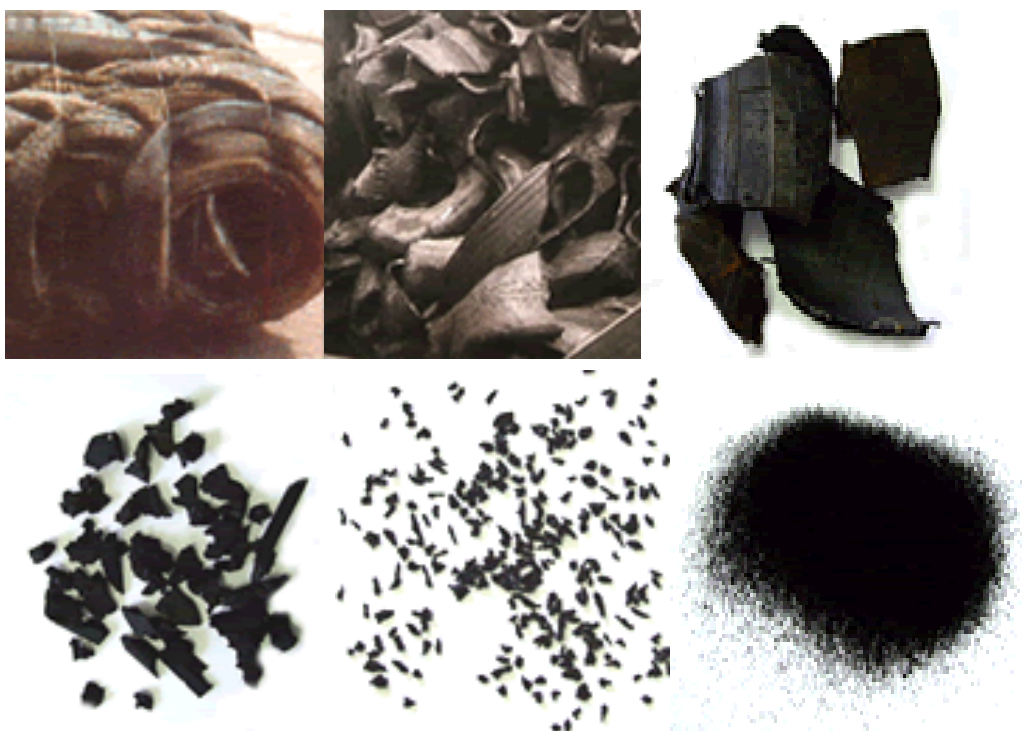
Slika 4.11. Usitnjavanje automobilskih guma do najmanje granulacije
