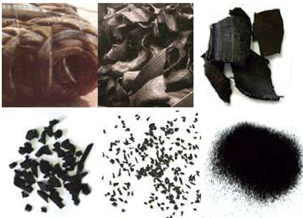
Slika 4.11. Usitnjavanje automobilskih guma do najmanje granulacije
