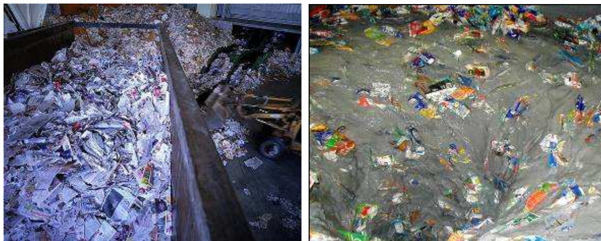
Slika 4.3. Prijem papira i proces njegovog ispiranja
