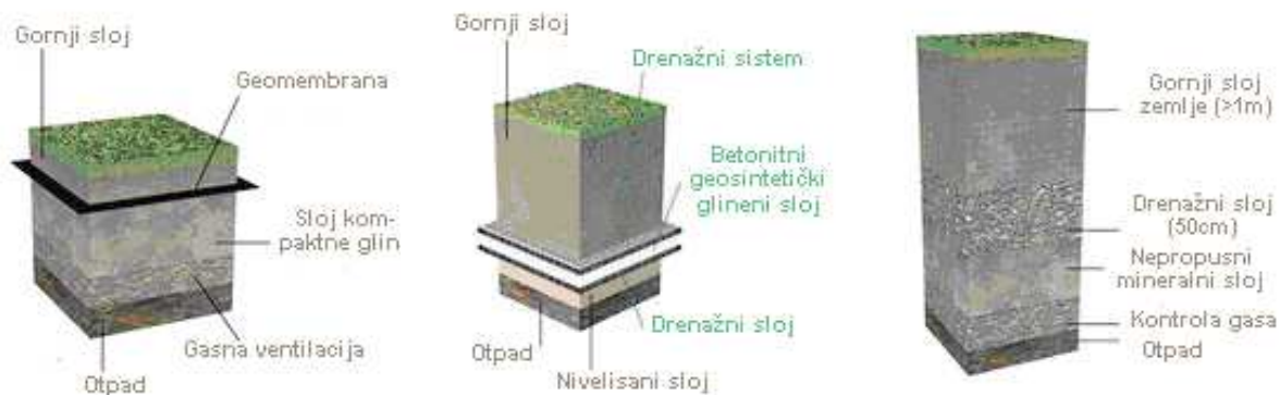
Slika 5.13. Prikaz gornjih pokrivnih slojeva deponije
