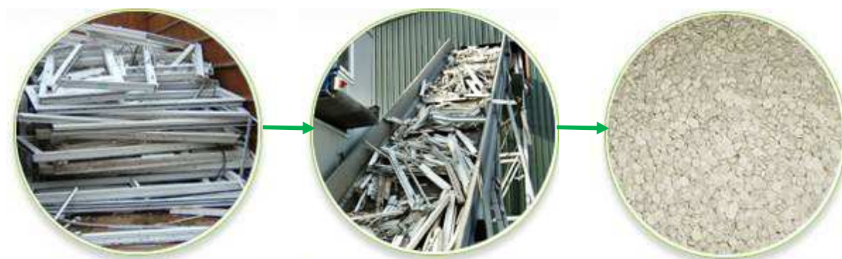
Slika 4.6. Dobijanje granulata od PVC prozora
