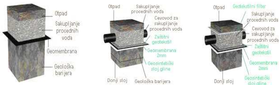
Slika 5.17. Prikaz donjih slojeva deponije
