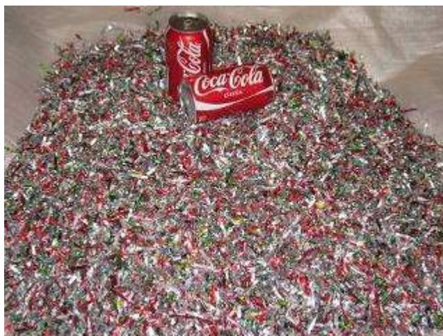
Slika 4.8. Usitnjavanje aluminijumskih limenki
