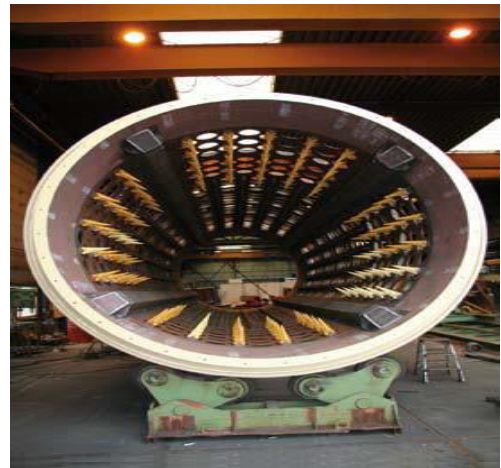
Слика 9: Ротационо сито за мешани комунални отпад
