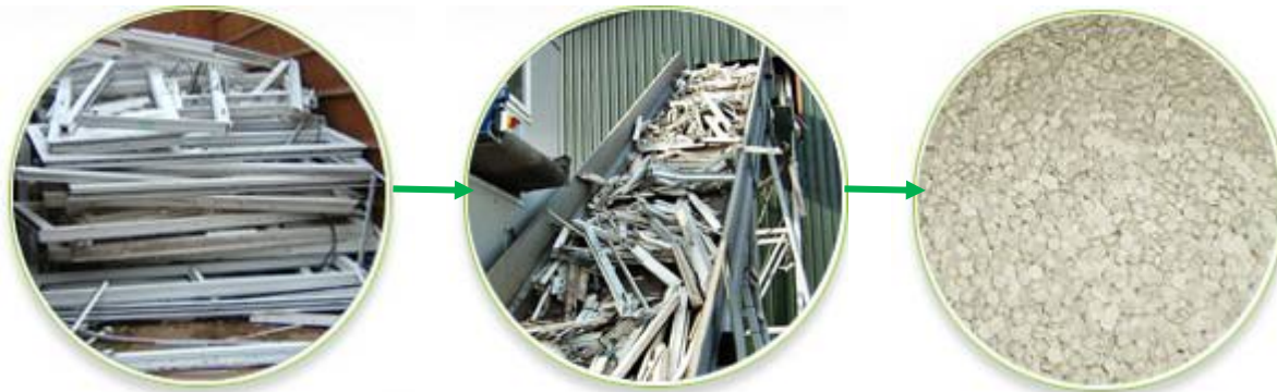
Слика 4.7 Добијање гранулата од PVC прозора
