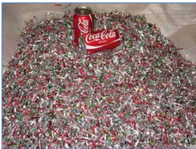
Слика 4.9 Уситњавање алуминијумских лименки
