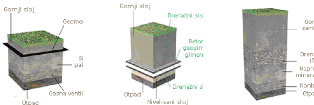
Слика 5.11: Приказ горњих покривних слојева депоније
