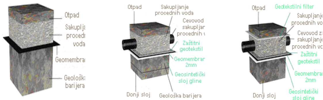
Слика 5.15: Приказ доњих слојева депоније
