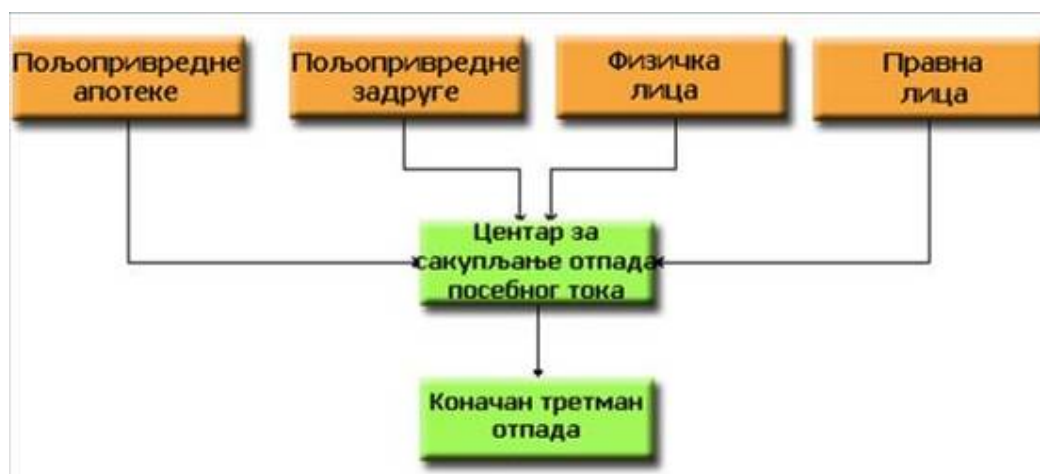
Слика 78 - Шема сакупљања отпада који садржи, састоји се или је контаминиран дуготрајним органским загађујућим материјама (POP's отпад).
