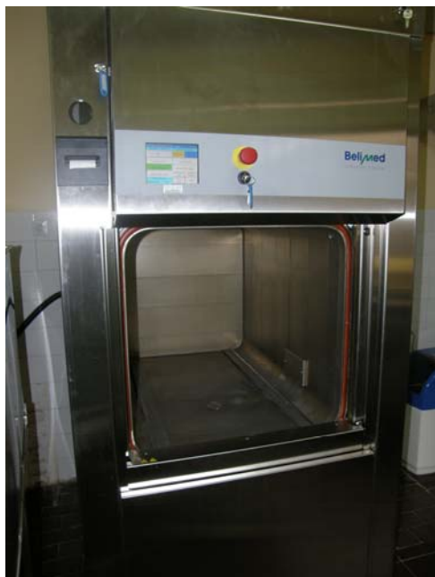
Слика 30 - Аутоклав за стерилизацију инфективног медицинског отпада
