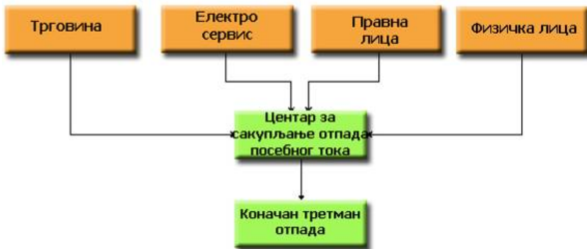
Слика 75 - Шема сакупљања отпада електронских-електричних производа
