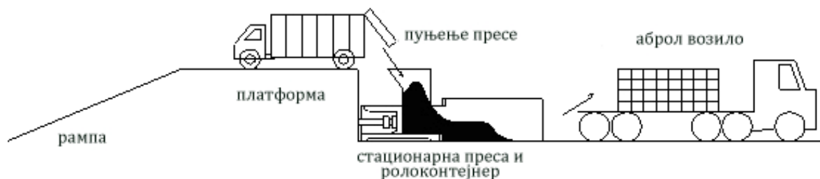
Слика 89 - Принцип рада трансфер станице
