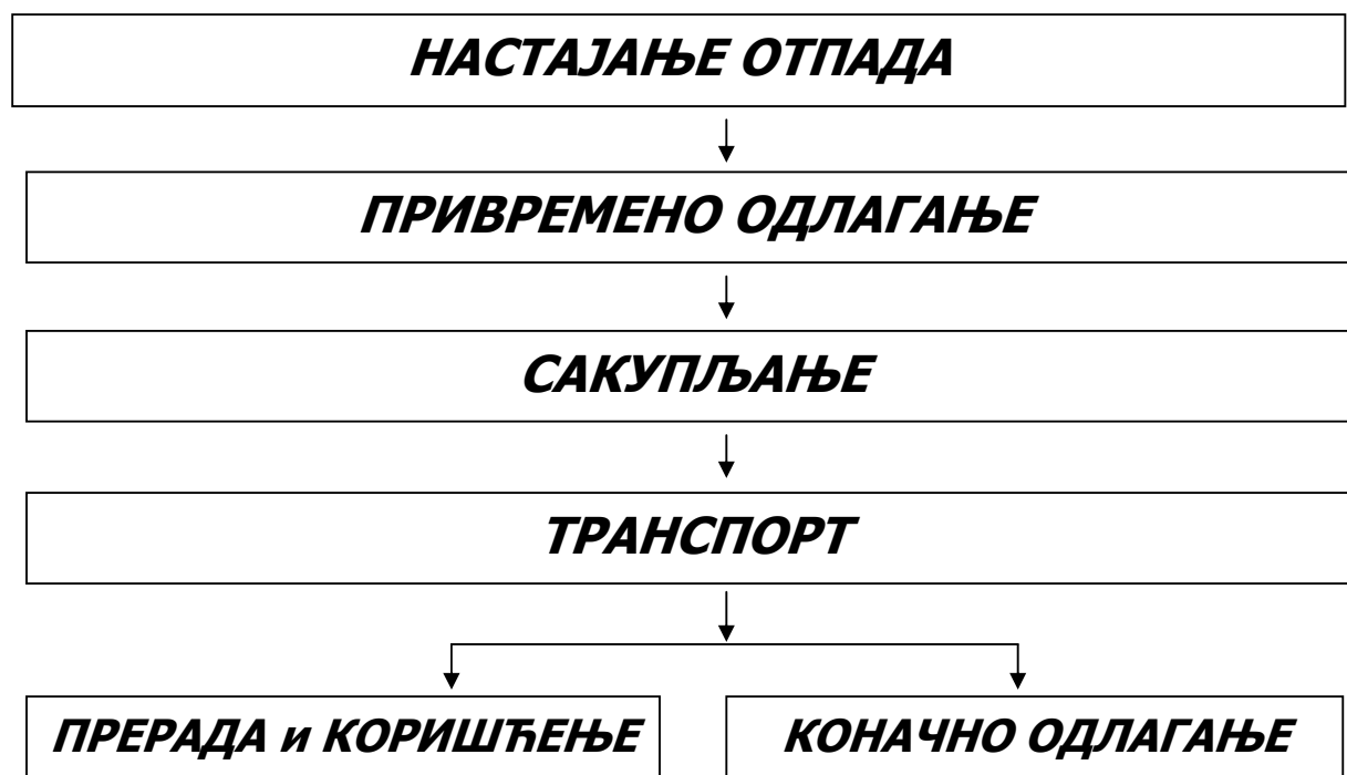
Слика 3 - Елементи интегралног система збрињавања отпада
