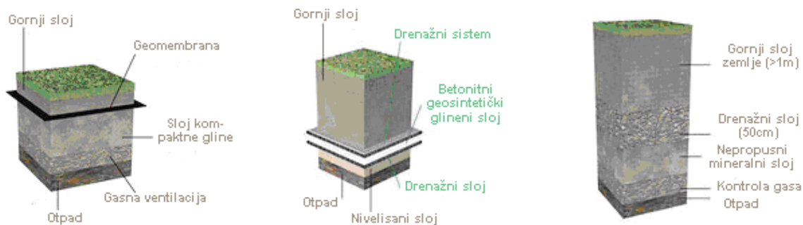
Слика 5.18 Приказ горњих покривних слојева депоније
