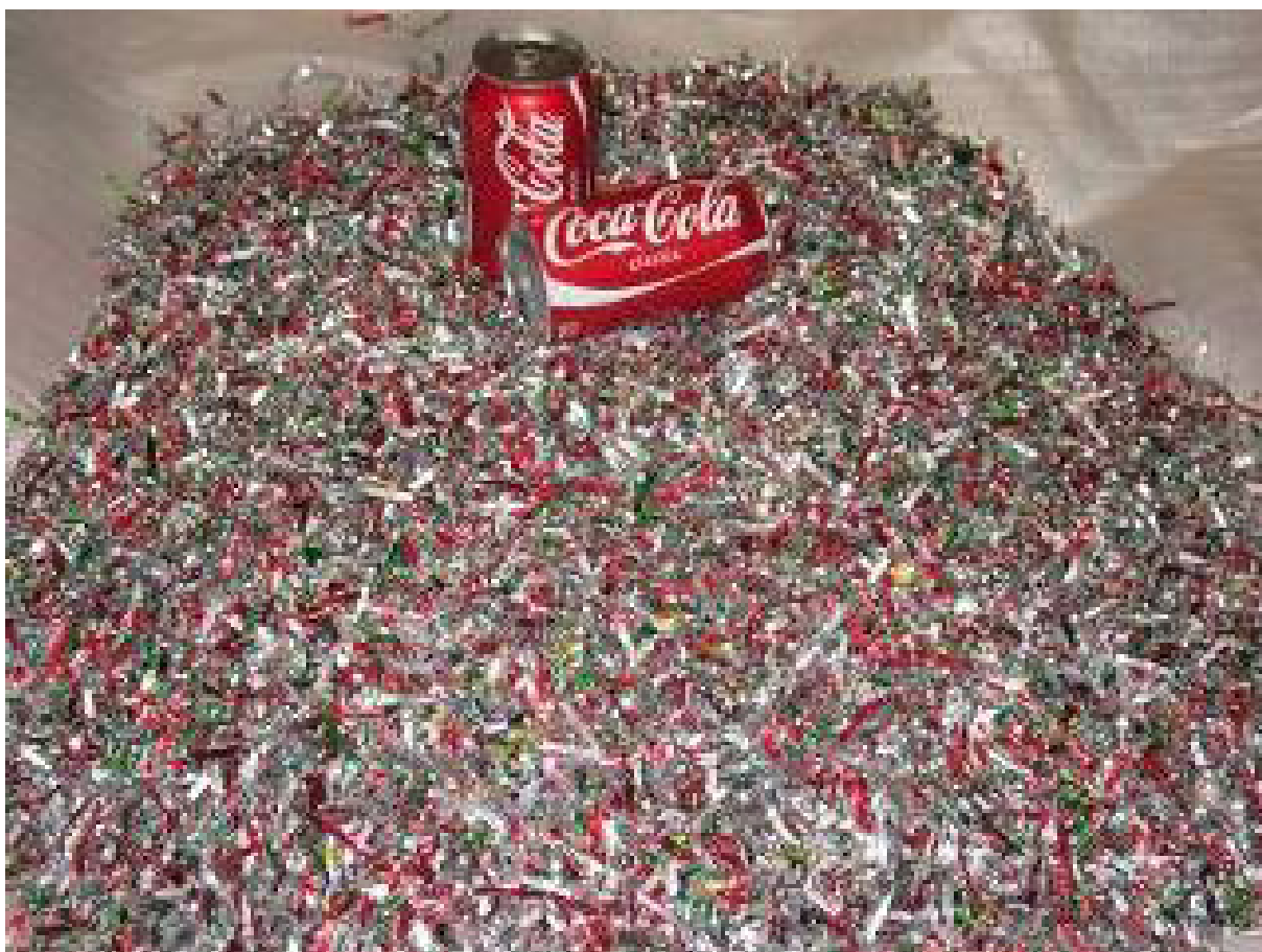
Слика 5.8 Уситњавање алуминијумских лименки
