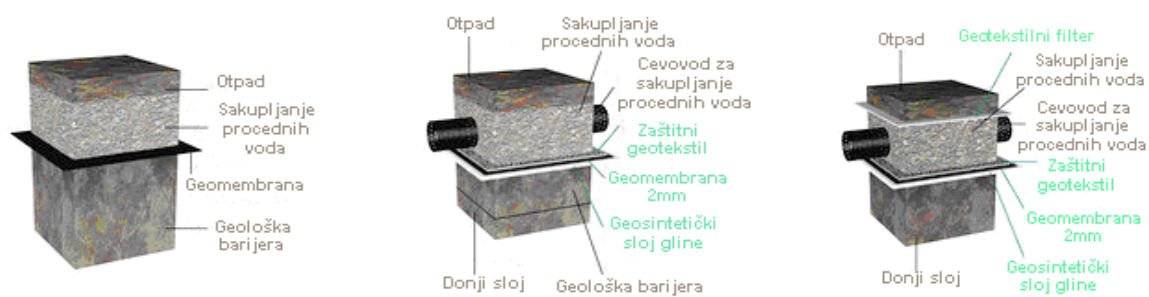
Слика 5.22 Приказ доњих слојева депоније
